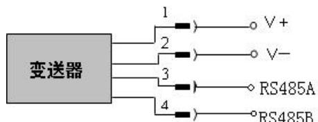
信号线可采用双绞线。在电磁干扰较严重的场合,建议使用屏蔽导线,并妥善接地。信号线不要与其它电源线一起穿金属管或放在同一线槽中,也不要在强电设备附近通过。
