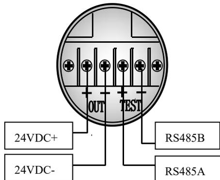
信号线可采用双绞线。在电磁干扰较严重的场合,建议使用屏蔽导线,并妥善接地。信号线不要与其它电源线一起穿金属管或放在同一线槽中,也不要再在强电设备附近通过。
