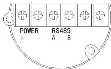
信号线可采用双绞线。在电磁干扰较严重的场合，建议使用屏蔽导线，并妥善接地。信号线不要与其它电源线一起穿金属管或放在同一线槽中，也不要在强电设备附近通过。
